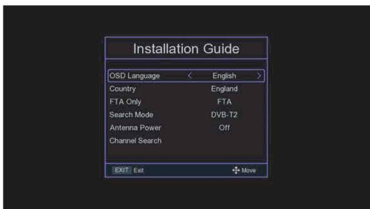
pas de câble de signal inséré ou si le signal câble est desserré, une petite fenêtre de "Lock Failed" apparaîtra, si le programme est trouvé avec succès, quittez l'écran d'installation et entrez dans le grand écran pour lire le programme.
