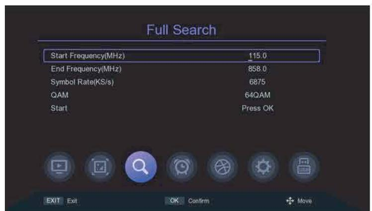
del espectro de frecuencias de búsqueda, no más de 858 MHz, el valor establecido de la tasa de símbolos no debe ser inferior a 2000 ks/s o superior a 7000 ks/s, alterne la configuración de QAM con el botón [◀/▶] Mueva el cursor a Inicio y, a continuación, pulse el botón (OK) Menú Búsqueda de programas.
