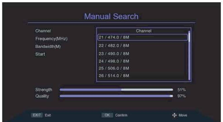
Pulse la tecla [▲/▼] para mover el cursor a la barra de frecuencia, pulse la tecla [◀/▶] para seleccionar la posición del parámetro de cambio, escriba la tecla numérica [0~9] para establecer el parámetro. Si la configuración se establece en menos de 50 MHz, aparece la barra de mensaje "Error de frecuencia, no debe ser inferior a 50,0 MHz". Si la frecuencia se establece en más de 870 MHz, se muestra la barra de mensaje "Error de frecuencia, no debe exceder 870.0 MHz" y pulse [OK] para salir.
