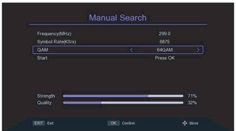
angezeigt, wenn die Signalqualität gut ist, wird sie violett angezeigt. Bewegen Sie den Cursor auf die Startleiste, drücken Sie [OK], um den Suchbildschirm aufzurufen und die Suche zu starten. Wenn das Signal nicht gesperrt ist. Es wird "LOCK Failed!" beim Drücken von [OK].
